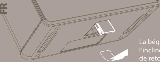
La béquille de l'Acoustic Pro, permettant de l'incliner pour une utilisation en moniteur de retour de scène, se rétracte dans la partie postérieure de l'ampli.
