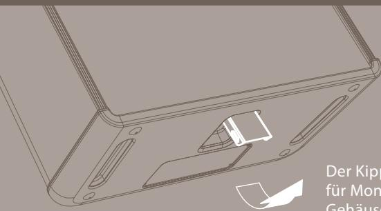
Der Kippständer des Acoustic Pro lässt sich für Monitoreinsätze aus dem Boden des Gehäuses ausklappen.
